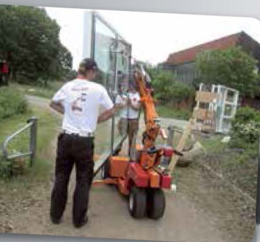
SL 380 Outdoor er som standard monteret til vindues og glasmontering, men kan leveres med specialanordning til håndtering af fx tunge branddøre og porte.
