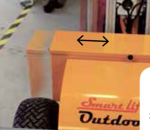
Liften har op til 100 mm sideforskydning til finjustering af vinduet ved montering.
